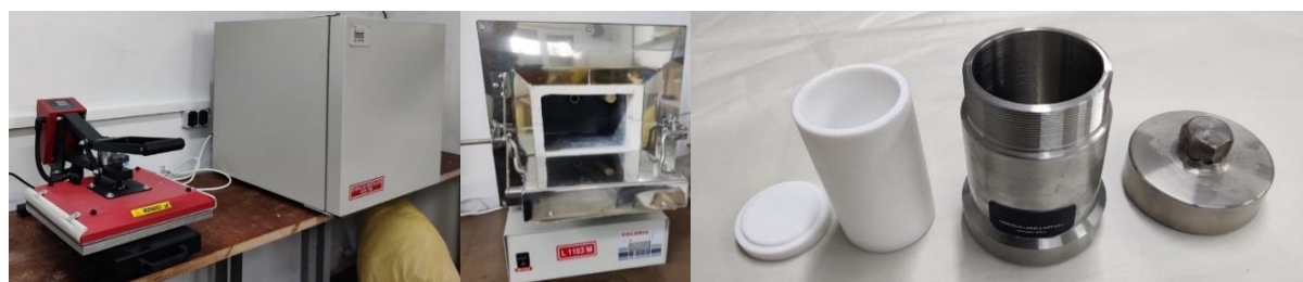
Figura 3. Imagini fotografice ale presei termice cu sertar, etuvei cu ventilație forțată, cuptorului de calcinare și autoclavei pentru sinteză hidrotermală.
