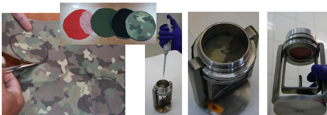
Verificarea capacității de protecție față de agenții chimici de război (iperită)
