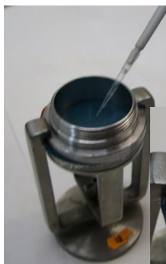
Verificarea capacității de protecție față de agenții chimici de război (iperită)
