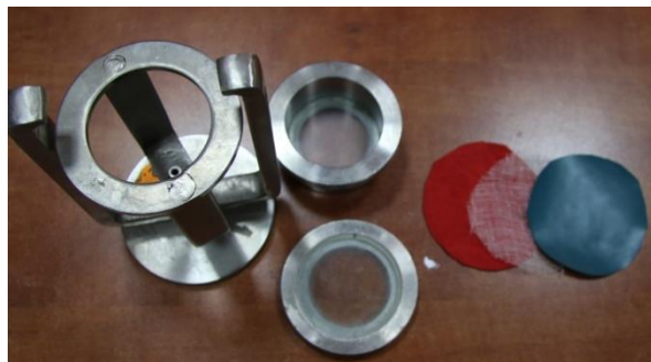
Verificarea capacității de protecție față de agenții chimici de război (iperită)
