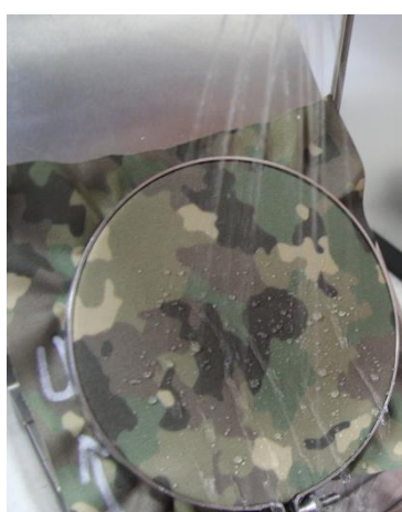
Fig. 13. – Verificarea rezistenței la stropire
