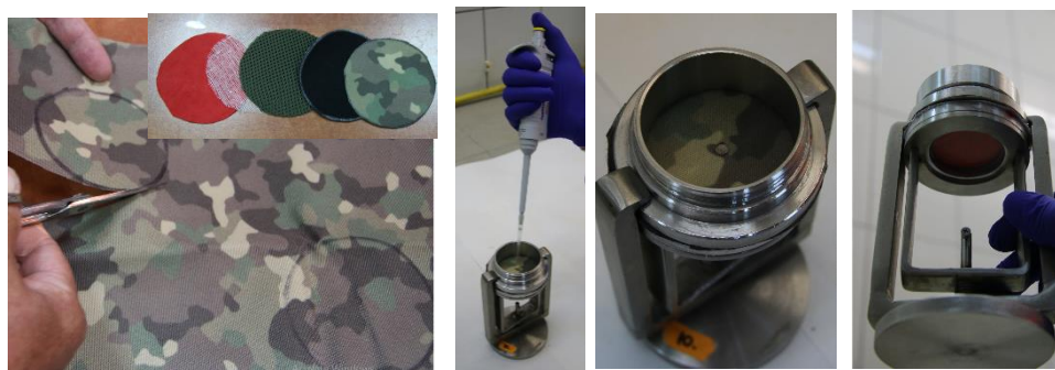
Fig. 4. – Verificarea rezistenței la agenți chimici de război
