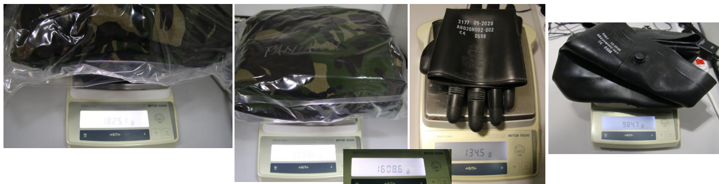
Fig. 3. – Verificarea masei costumului pe elemente componente
