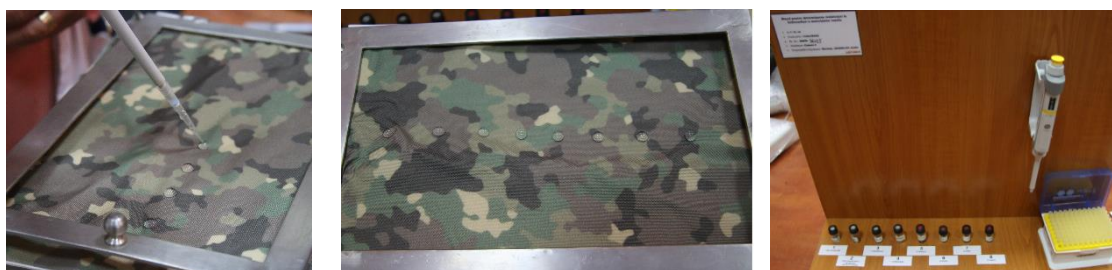
Fig. 12. – Verificarea rezistenței la hidrocarburi
