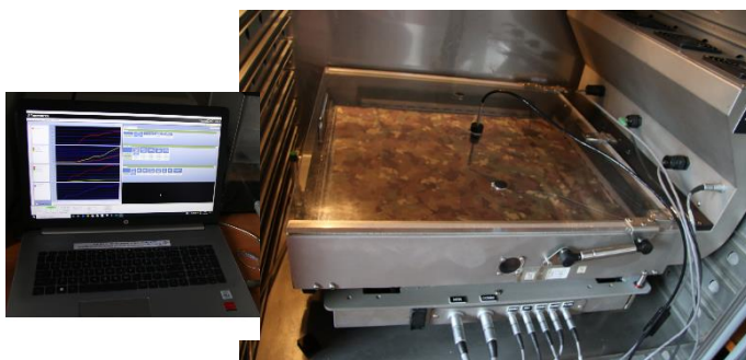
Fig. 6. – Verificarea rezistenței termice
