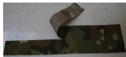
Fig. 10. – Formă epruvetă testare la sfâșiere
