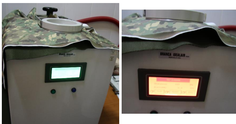
Fig. 5. – Verificarea permeabilității la aer
