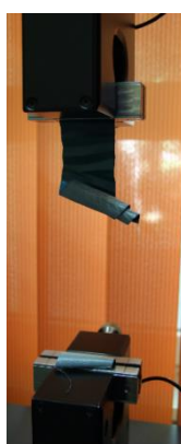
Fig.9. – Verificarea rezistenței la tracțiune/ forța maximă
