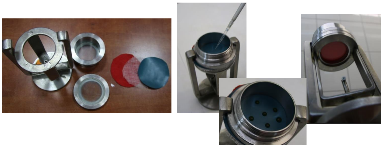
Fig.7. – Capacitatea de protecție față de ACR lichizi a materialelor de confecție suport textil/poliesteric acoperit cu cauciuc butilic
