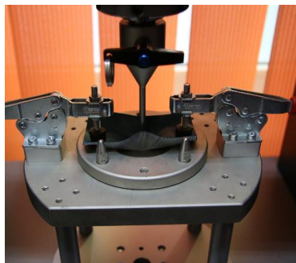
Fig.14. – Verificarea rezistenței la perforație
