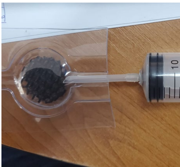
Fig. 4 Test de umplere cu fluid a celulelor folosind un tub lung cu diametru mare
