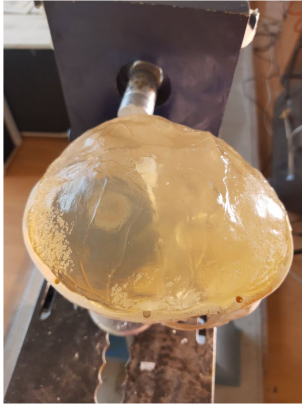
Fig. 7 Modul de dipunere al senzorului de presiune vizibil prin blocul de gelatina balistică translucid
