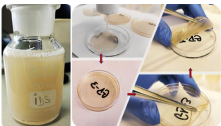
Figura 2 – Soluție de decontaminare (aplicarea soluției pe suprafața contaminată, uscarea și exfolierea filmului polimeric)
