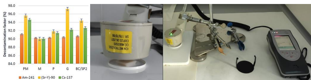
Figura 15 – Eficiența decontaminării radionuclizilor de pe diferite tipuri de suprafețe
