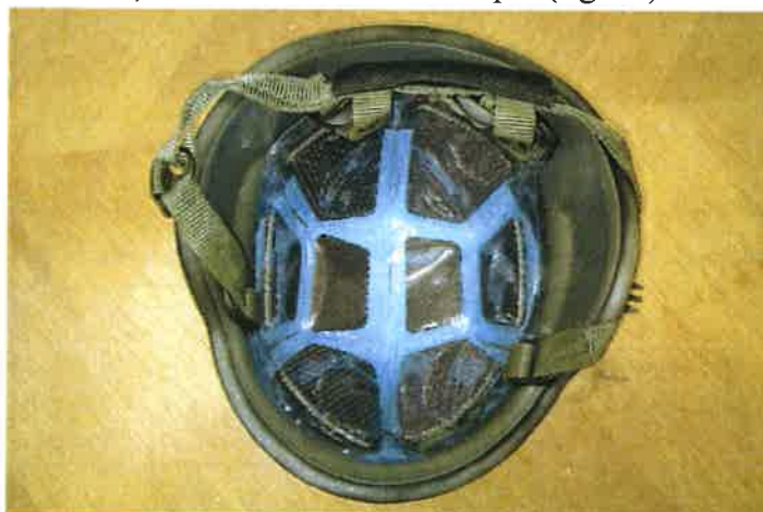
Fig.3.2 Dispunerea matricei celulelor de amortizare în interiorul căștii
