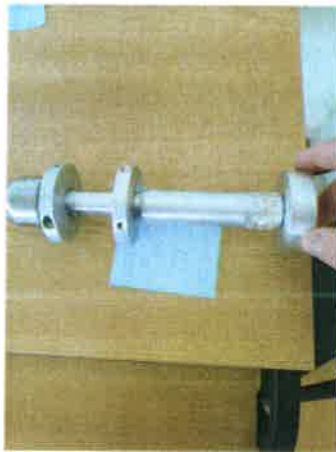
Fig.1.13 Proiectil cu cap sferic concav (stânga) și cu cap plan (dreapta)
