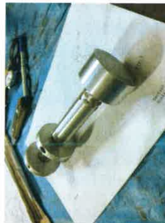
Fig.1.13 Proiectil cu cap sferic concav (stânga) și cu cap plan (dreapta)
