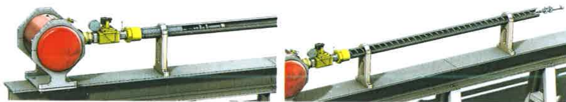
Fig.5.1 Cablu restrâns (stânga) înainte de tragere și întins (dreapta) după tragere
