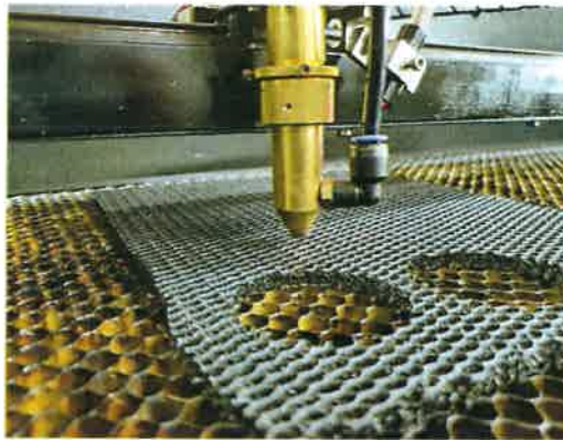
Fig.1.5 Tăierea cu laser a eșantioanelor de material poros
