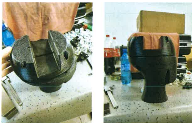
Fig.4.1 Imagini cu surogatul pentru cap conceput conform prevederilor NIJ NIJ-STD-0106.01
