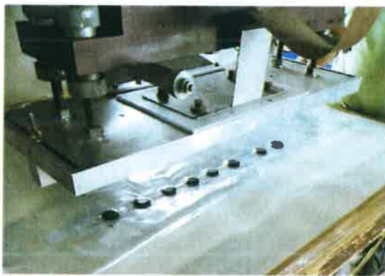
Fig.1.4 Matrița utilizată la fabricarea celulelor de amortizare
