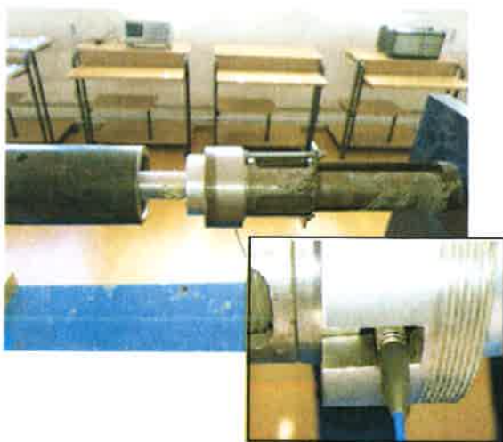
Fig.1.10 Cap de impact și țintă pentru impactul plan
