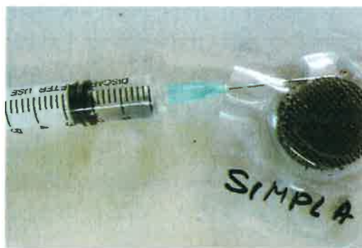
Fig.1.6 Umplerea cu fluid a celulelor
